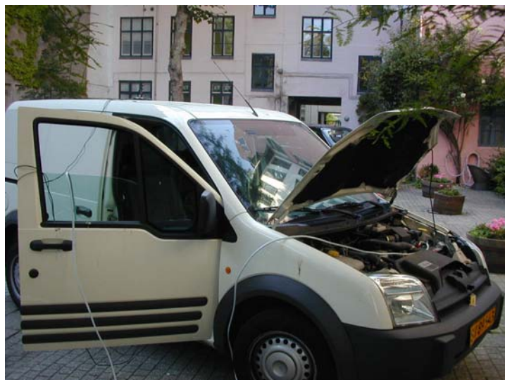
Figur 27 Klarøring af målebil. 220V skaffes med en switch-mode converter fra batteriet.
