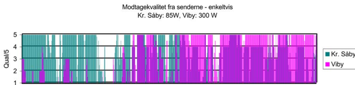
Figur 31 Sammenligning af kvaliteten som funktion af positionen (samme x-akse som figur 30).
