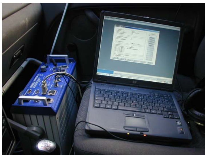
Figur 28 Audemat FM-MC4 og PC til dataopsamling.
