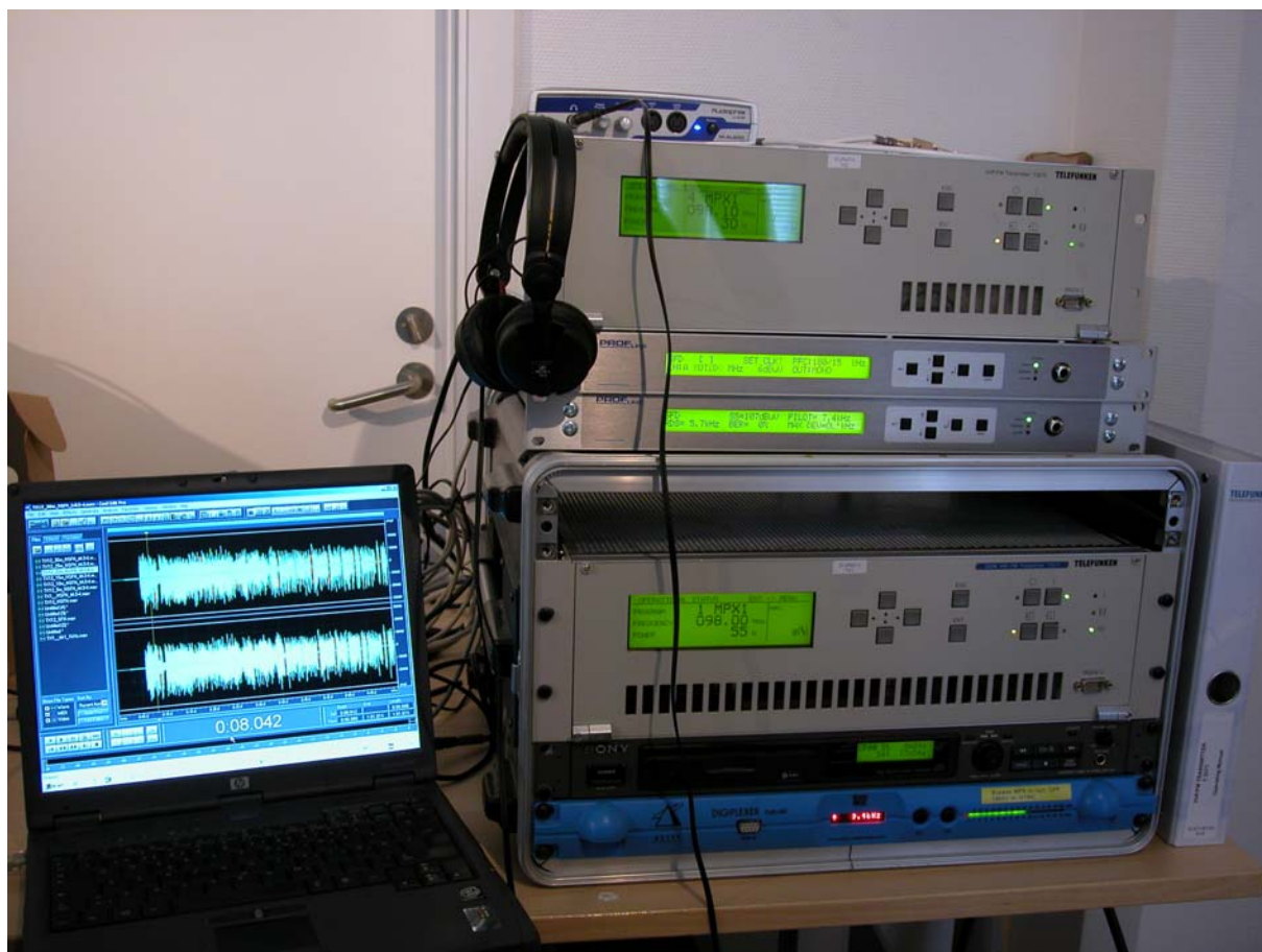
Figur 14 Forsøgsopstilling. PC'en blev brugt til at optage lyden fra måletuneren. Th. fra oven: USB lydkort til PC, Telefunken 100W sender, 2 Proline SFDx retransmissionstunere, Telefunken 250W sender, CD afspiller med programmateriale, AZTEC RDS & Stereo encoder.
