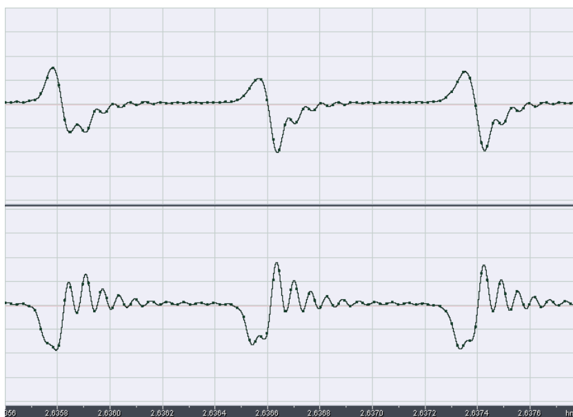
Figur 19 SFN-støj, når den ene sender er Crown og den anden Telefunken. Lydniveauet her er -20 dBFS, og skalaen for neden er sec.
