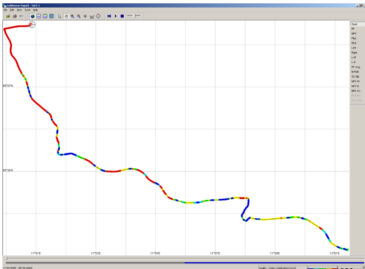
Figur 26 Ruten mellem de to sendere. Farverne angiver kvaliteten. Senderen i Kr. Såby er øverst tv. og senderen i Viby er nederst th. Ved den viste måling blev der kun sendt fra Kr. Såby, med 85 W tilført effekt.
